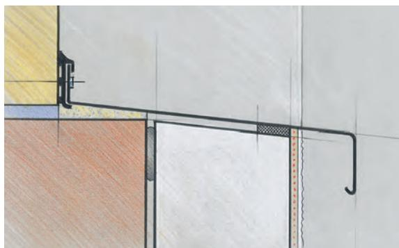
**Abb. 4: Alternativ erfolgt der Einbau der Fensterbank stumpf mit Wetterschenkel**
