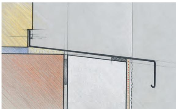
**Abb. 3: Der zurück gesetzte Einbau der Fensterbank setzt ein entsprechendes Fenster-Basisprofil voraus**
