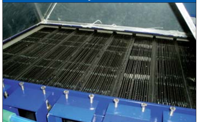
Abb. 4: Austauschflächen im geöffneten Absorber
