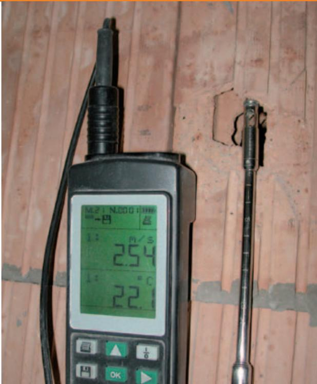
In Kombination mit dem Blower-Door-Test können mit Hilfe des Thermo-Anemometers Undichtheiten in der Luftdichtheitsschicht und im Mauerwerk aufgespürt werden.
