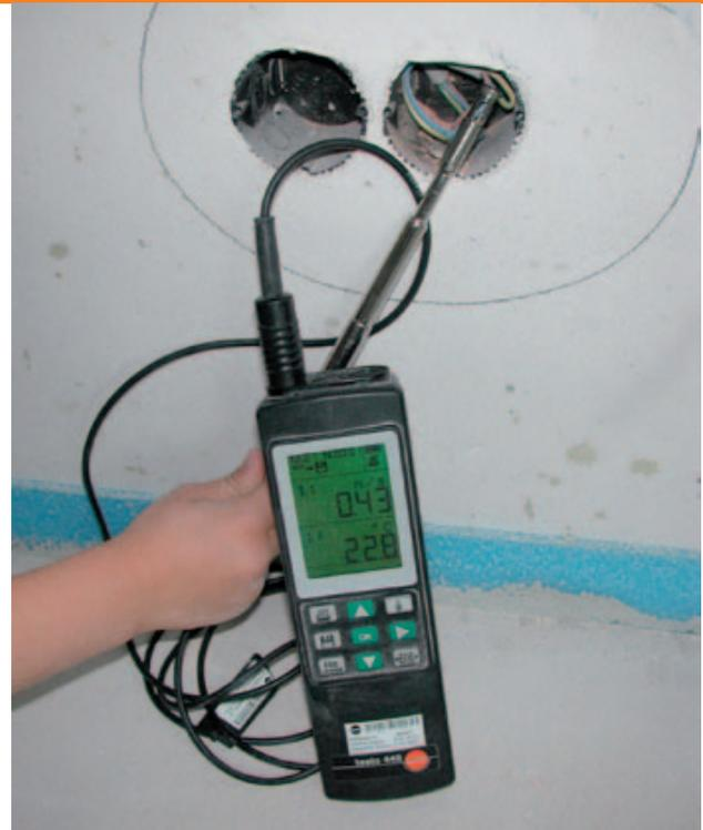
Auch die Undichtheiten die durch Kabeldurchführungen entstehen werden so sichtbar gemacht.
