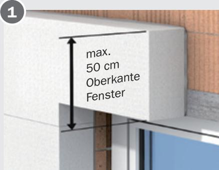
**Allgemein:** Abstand von max. 50 cm zwischen Unterkante Sturz und Unterkante Brandriegel einhalten, ggf. EPS-Dämmplatte horizontal auf entsprechende Höhe schneiden.
