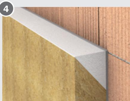
EPS-Dämmkeil einlegen und ebenfalls vollflächig verkleben
