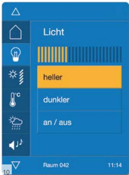
10 | Gebäudesteuerung über komfortable Bedienpanels User-friendly screens for building control systems
