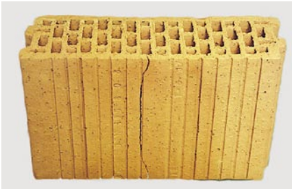
Bild 14: Ziegel mit Trocknungs- oder Brennrisse
