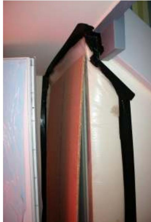
**Abbildung 45: Eingebaute Blower Door in einer Hauseingangstür und für die Messung temporär abgedichtete Kellertür.**
