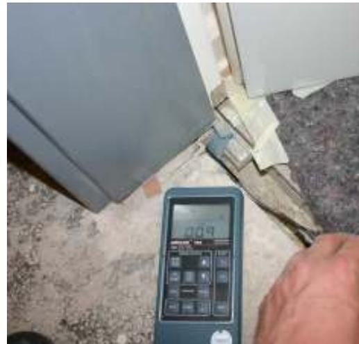
Abbildung 54: Links: Fehlstelle auf dem Treppenabsatz (Podest EG). Rechts: Leckage im Bereich der noch fehlenden Türschwelle (EG Whg.).
