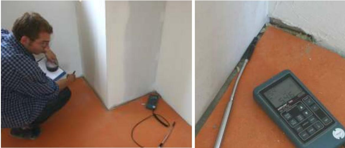
Abbildung 52: Links: Massive Leckage am Schornsteinschacht in der DG Whg. Haus 42. Rechts: Detail Fußboden/Schornsteinschacht mit sehr hoher Strömungsgeschwindigkeit (5,5 m/s) im gesamten Anschlussbereich Schachtverkleidung zum Fußboden.
