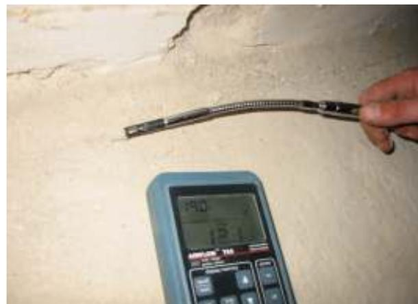
**Abbildung 21: ... hier treten beim Drucktest (50 Pa Unterdruck) erhebliche Luftströmungen auf**
