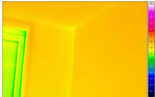
**Abbildung 185:** Tevesstraße 40. Es handelt sich um ein 'Mittelhaus', daher grenzt die Wand rechts an das ebenfalls warme Nachbargebäude; Wärmebrücken sind nicht erkennbar.
