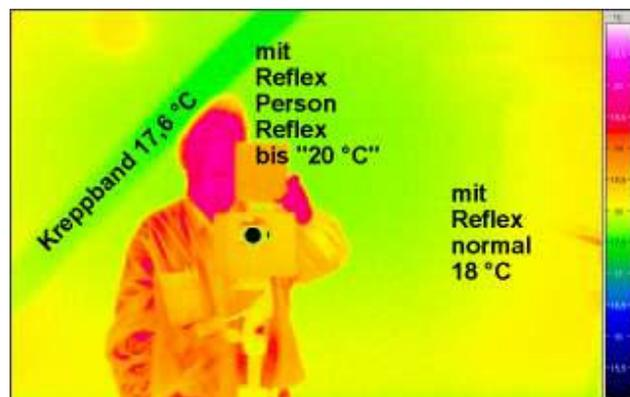
**Abbildung 189 links: Fenster mit Klebestreifen zur Bestimmung der tatsächlichen Oberflächentemperatur mit der IR-Kamera.**
