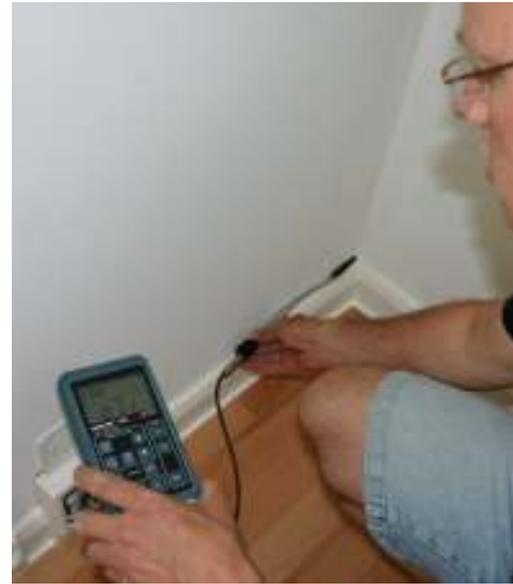
Abbildung 51: Links: Leckage an einer Fenstertür unten. Rechts: Luftströmung über der Fußleiste in einem Zimmer.
