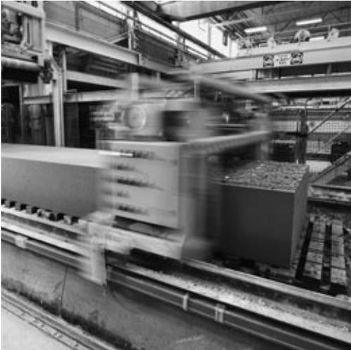
Schneiden und Profilieren der bis zu 8,0 m × 1,5 m × 0,75 m großen Blöcke.
