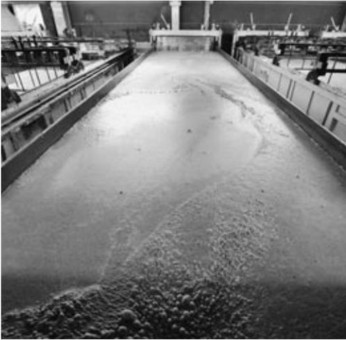
Fertig befüllte Gießform zu Beginn des Treibvorgangs.
