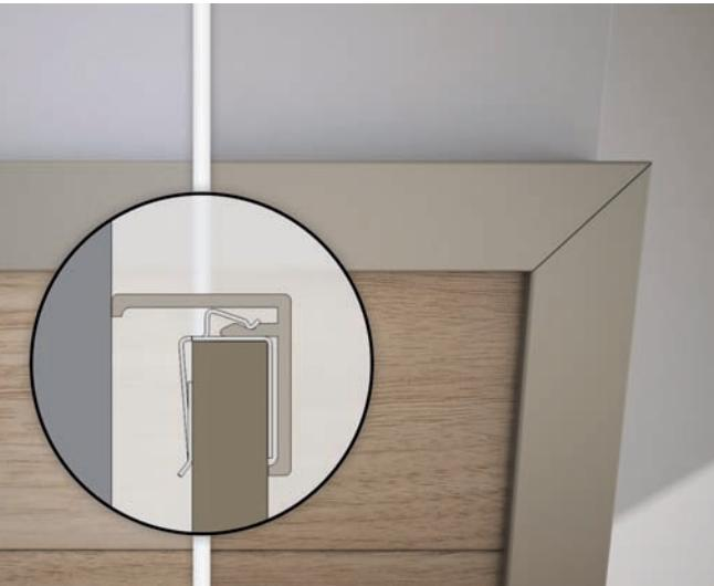
Abschlussprofile (E) zuschneiden und montieren
