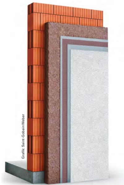
Abb. 1: Systemaufbau für hochdämmendes Ziegelmauerwerk: Hochleistungsziegelleichtputz, Armierungsmörtel mit Gewebeeinlage, mineralischer Oberputz
