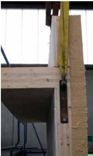
Die Außenwanddämmung wurde hierfür auf einer Massivholzwand montiert.
