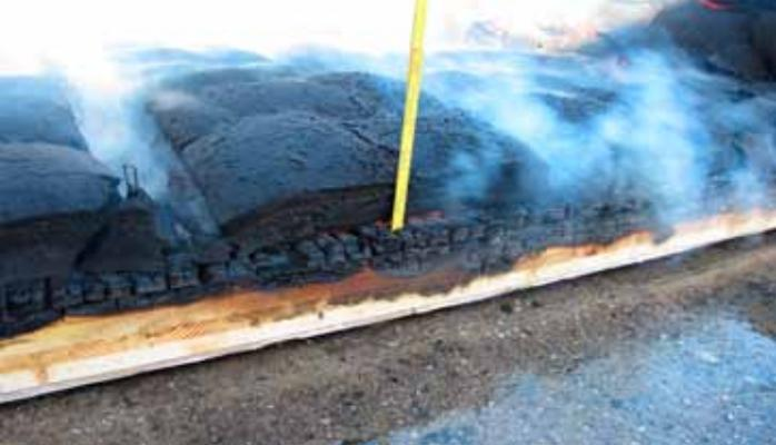
Der Durchbrand wird verzögert, da die bereits verkohlte Schicht den Flammen den Nährboden entzieht.
