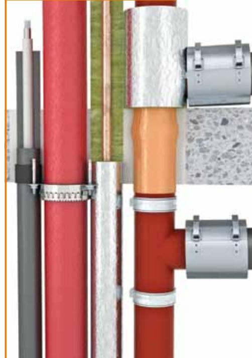
Egal ob Trinkwasser-, Heizungs- und Rücklaufleitungen, Abwasserrohre aus Guss oder Kunststoff – wir bieten Ihnen positiv geprüfte Systeme in einer lediglich 150 mm dicken Massivdecke mit 0 mm Abstand von System zu System. Eine zusätzliche Schachtwandverkleidung ist nicht notwendig.
