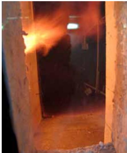
Auch diese gedämmte Konstruktion hielt den Flammen in der Brandkammer mehr als 90 Minuten stand.
