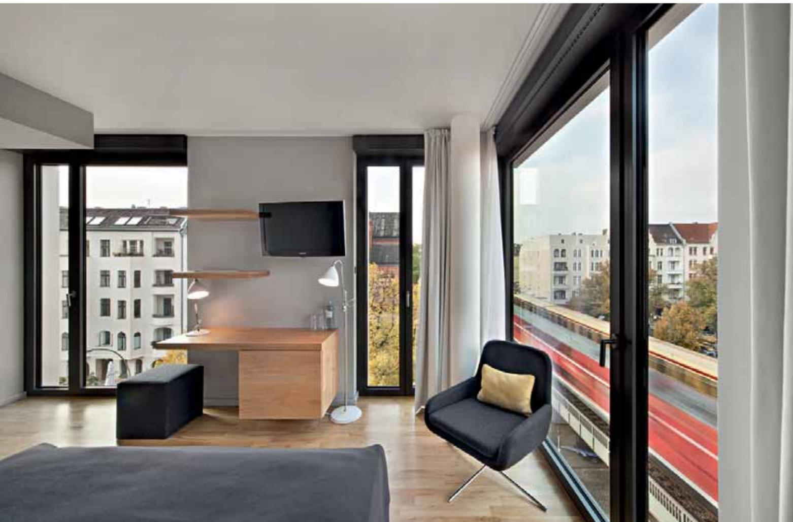
Die Nordfassade liegt 10 m von der Hochbahn entfernt, deshalb verfügen die Fenster über eine hohe Schallschutzklasse
