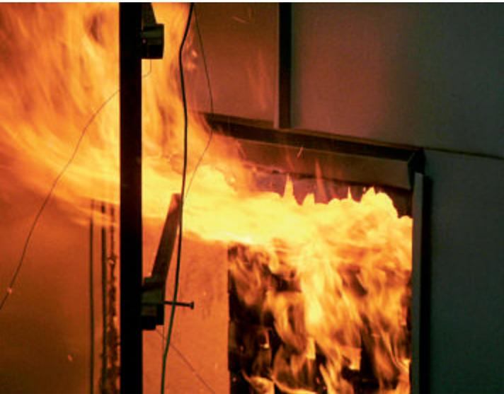
Ohne Beanstandung: Brandprüfung an vorgehängter hinterlüfteter Fassade.
