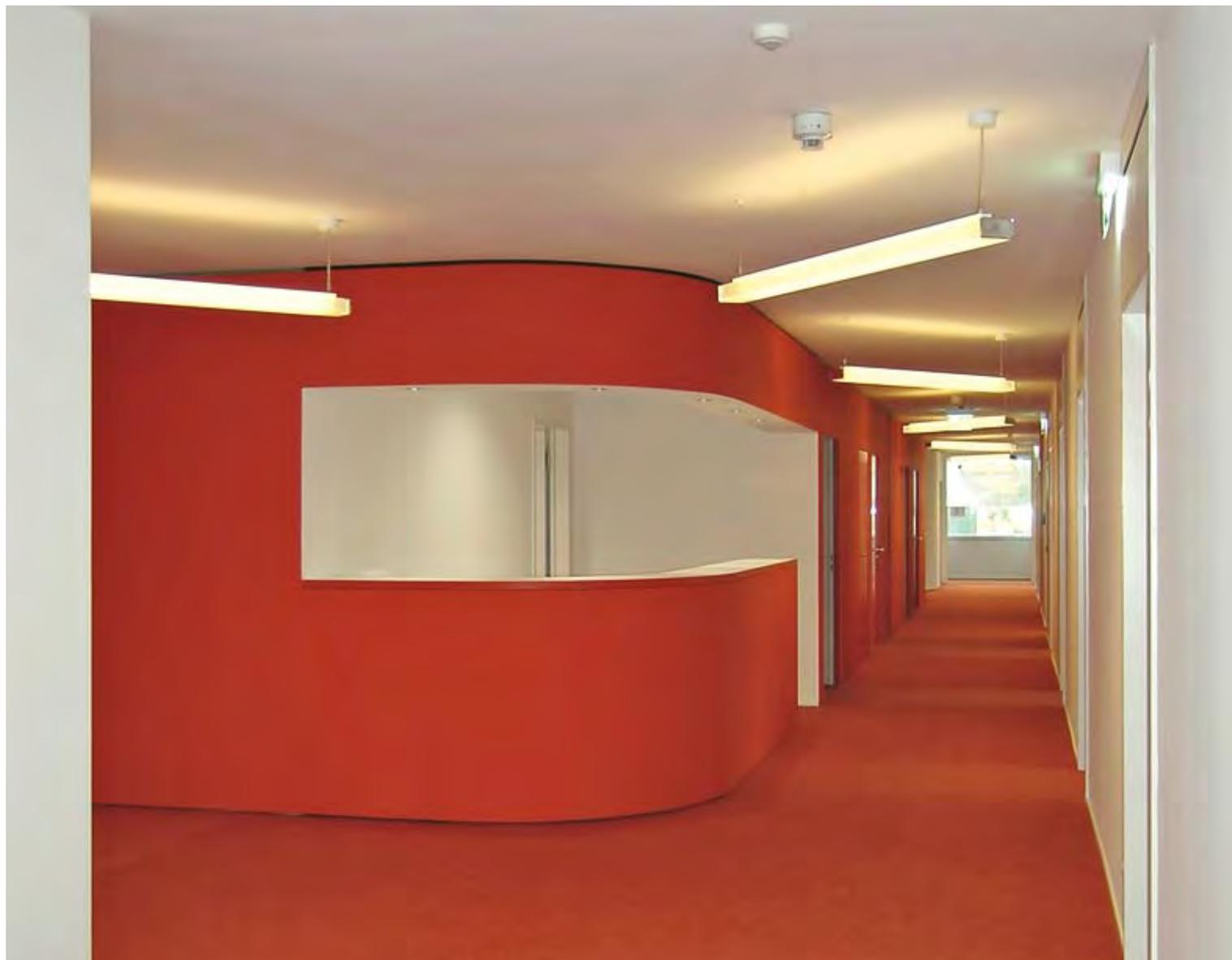
Die Kerne enthalten auf jeder Geschossebene Funktions- und Technikräume sowie eine offene Teeküche. Über den Türen sieht man die Überströmschlitze für die Abluft aus den Büros; durch die Schattenfuge zwischen Wand und Decke wird die Abluft abgesaugt und zur Wärmerückgewinnung genutzt
