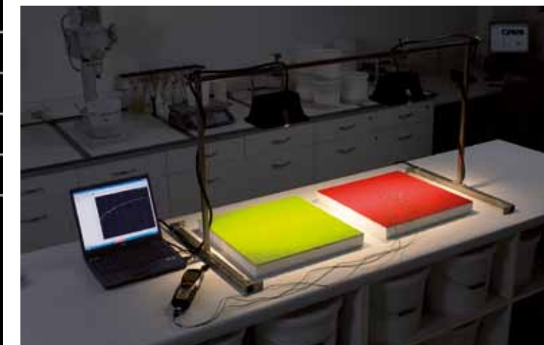
Trotz sehr viel niedrigerem HBW bleibt der rote, TSR-formulierte Farbton deutlich kühler als der hellere Grauton.
