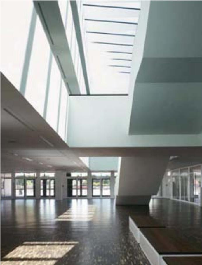
Tageslicht ersetzt weitestgehend künstliche Beleuchtung: durch einen Lichtschacht dringt Sonnenlicht bis ins Erdgeschoss und in die Pausenhalle
