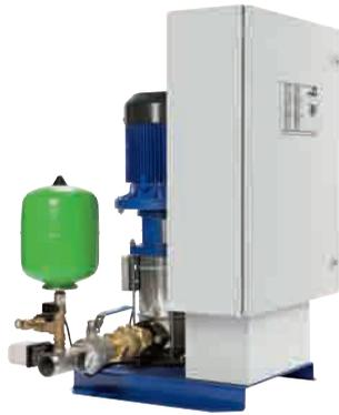
penanlage „Hya-Solo D FL“ und die Doppelpumpenanlage „Hya-Duo D FL“ der seit April 2009 geltenden neuen Fassung der DIN 14 462 für Löschwassereinrichtungen. Ihre maximale Fördermenge beträgt 110 m<sup>3</sup>/h bei einer Förderhöhe von bis zu 160 m.
