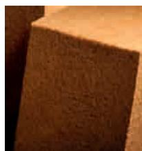
Das Temperaturleitverhalten der Dämmstoffe aus Holz- und Zellulosefasern von Homatherm ist durch die hohe Wärmespeicherkapazität sehr träge, dadurch wird die Hitze stark verzögert in das Bauteil abgegeben. Hinzu kommt, dass die Oberflächen nur verkohlen und so eine Schutzschicht bilden, die den weiteren Abbrand
