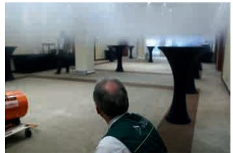
Auf Grundlage der Empfehlungen aus den Simulationen wurde eine mechanische Rauchabzugsanlage für die Hotelhalle geplant und eingebaut.
