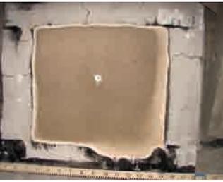
MC-Bauchemie hat einen Instandsetzungsmörtel mit höchster Brandbeständigkeit entwickelt. Der kunststoffmodifizierte Zementmörtel „Nafufill KM 250“ erfüllt u.a. die Anforderungen der Rijkswaterstaat (RWS) an Baustoffe für den baulichen Brandschutz bei Konstruktionen im Tunnelbau. Bei der europaweit strengsten Prüfung für diesen Anwendungsbereich wird der Baustoff in einem zweistündigen Brandversuch
