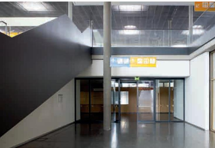
**Bild 5:** Landesmesse Baden-Württemberg, Stuttgart: Die Übergänge zwischen Halle A1 und dem angrenzenden Garderoben- und Umlaufbereich sind durch 2,80 m hohe, zweiflügelige T30-Türsysteme abgesichert
