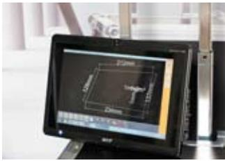
Das lasergestützte Aufmaßsystem „Flexijet“ ist in der per Fingergesten intuitiv bedienbaren Version „FlexijetPAD“ erhältlich. Bei dieser Aufmaßlösung wird die Hard- und Software über einen Tablet-PC intuitiv gesteuert. Damit ist das aus einem Laserdistanzmessgerät von Leica, einem Stativ und einer Aufmaßsoftware bestehende System auch für Laien einfach bedienbar, denn das Bedienungsprinzip folgt den vielen Planern und Handwerkern
