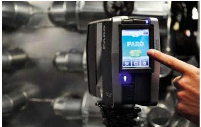
Mobil und leicht bedienbar: Der „Faro Focus3D“ ist ein kompakter Laserscanner und dient der Erfassung von Baugruben, Rohbauten und Gebäuden
