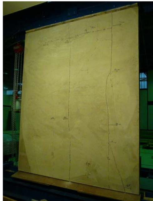
**Abb. 51** Rissbildung nach Lastzyklusversuch DG-PS-5
