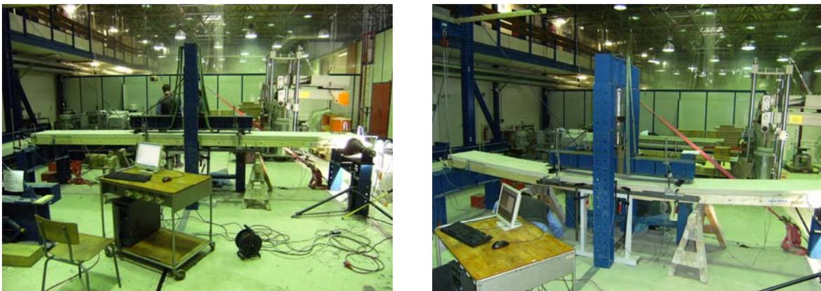
**Abb. 95** Versuchsaufbau Biegeversuch vor Belastung (links) und bei Maximalbelastung (rechts)
