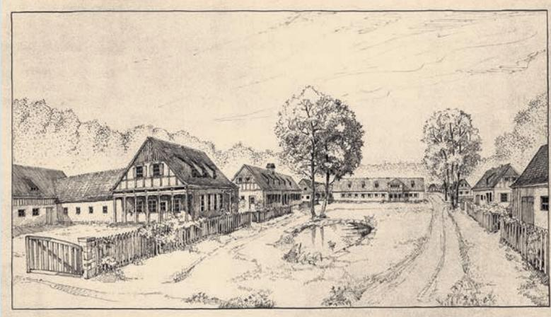
Perspektivische Ansicht des Verfassers auf die Gesamtanlage. Die Gehöfte sind der „ostpreußischen Bauart“ entsprechend in fachwerk- und blockbauweise ausgeführt und mit Stroh gedeckt
