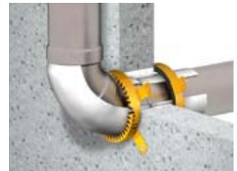
im Brandfall verkürzte Reaktionszeiten. „Curaflam EcoPro“ kann bis zu einem Außendurchmesser von 160 mm um alle handelsüblichen schallisolierenden Abwasserrohre montiert werden. Auch Versorgungsleitungen aus PE oder PVC sowie Mehrschichtverbundrohre bis zum Außendurchmesser von 110 mm stellen kein Problem dar. Zusätzlich zu den bekannten Rohrarten können jetzt auch „Wavin SiTech“ und „Geberit Silent-PP“ abgeschottet werden.
