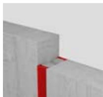
Die Wirkungsweise der neuen Fugendichtmasse beruht im Brandfall auf der Bildung einer geringfügig volumenergrößernden, wärmedämmenden Schicht. Von der MFPA Leipzig geprüft wurden massive Decken- und Wand-
