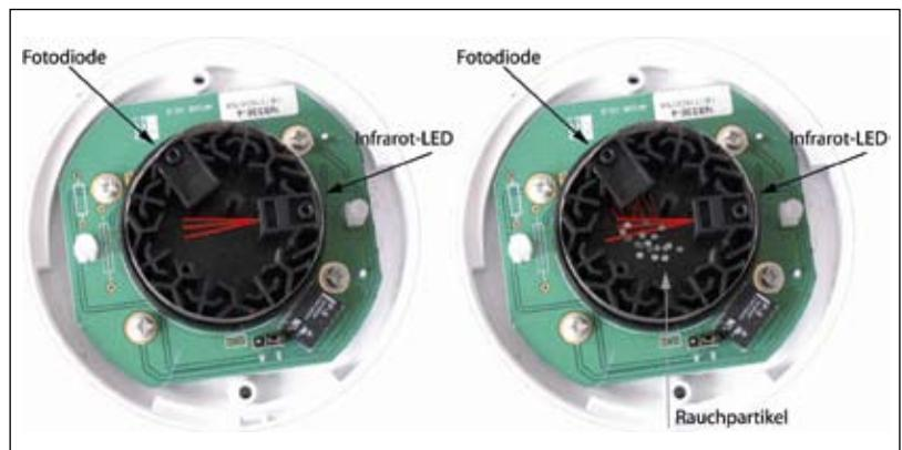
Sobald Rauch in die Messkammer eintritt, wird das Licht der Infrarot-LED gestreut und trifft auf die Fotodiode
