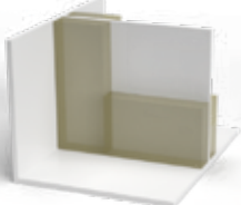
Schacht mit teilhoher Vorwand
