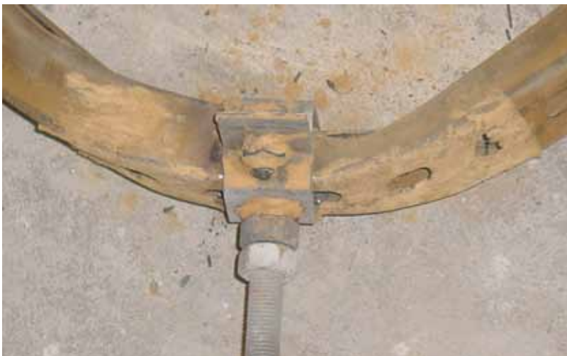
Ergebnis eines 90-minütigen Brandversuches – Verformung einer brandgeprüften „MPC-Schiene“ 38_40 mit Feuerwiderstandsdauer F90.
