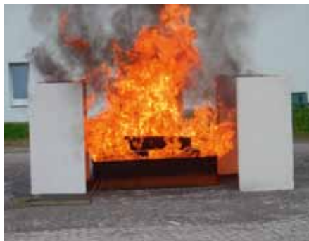
Test des Brandverhaltens an maschinengeführten Hydraulikgeräten; Nachweis der Unbedenklichkeit.
