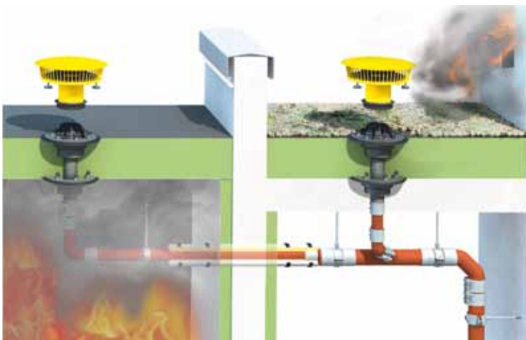
Brandweiterleitung vorgebaut – eine Flachdachentwässerungsanlage mit nicht brennbaren SML-Rohren und „SitaMulti“-Gussgully, hier mit gelbem Anstauenelement für die Notentwässerung.
