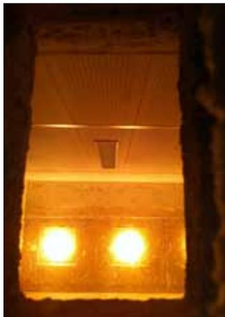
Brandprüfung eines Knauf AMF Deckensystems.
