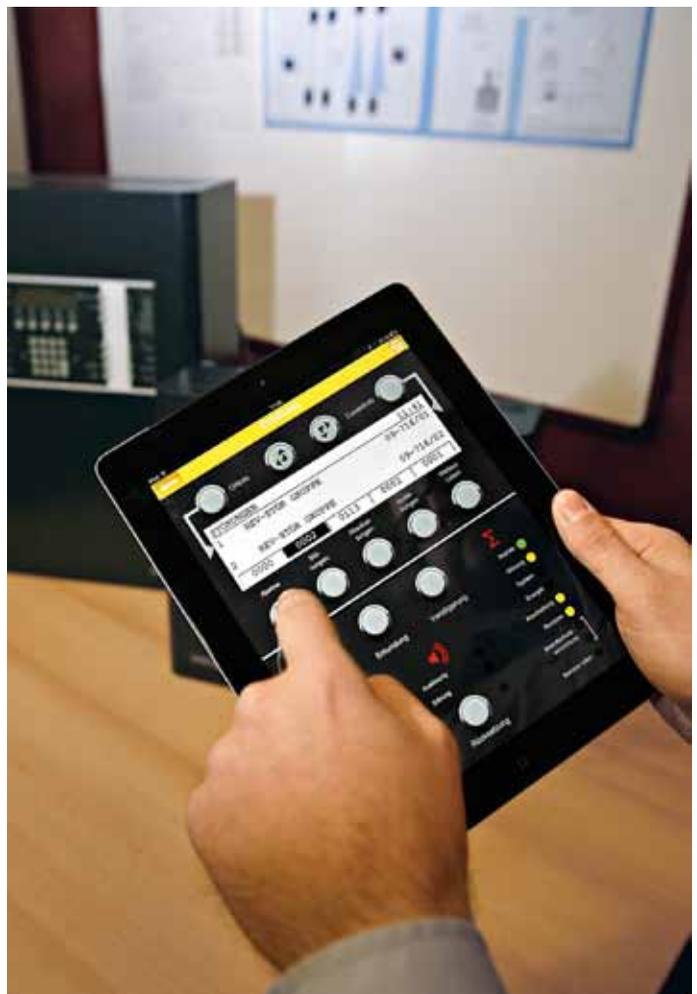
Die virtuelle Bedienoberfläche auf dem mobilen Endgerät – hier einem iPad – entspricht exakt dem Erscheinungsbild der realen Anlage.
