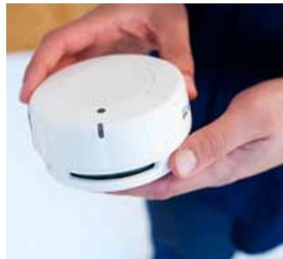
Das integrierte Funkmodul der „fumonic 3“-Rauchwarnmelder ermöglicht deren Einbindung in das Funksystem „symphonic sensor net“.
