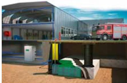
Um diese zu schließen, müssen Löschwasserbehälter nachgerüstet werden, die die Versorgung im Notfall garantieren. Bestehend aus den „Rigofill inspect-Blö-
