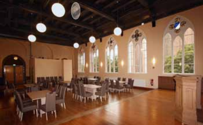
Die ehemalige Aula mit ihrer historischen Holzdecke. Sprinkler sind auf den ersten Blick kaum erkennbar.
