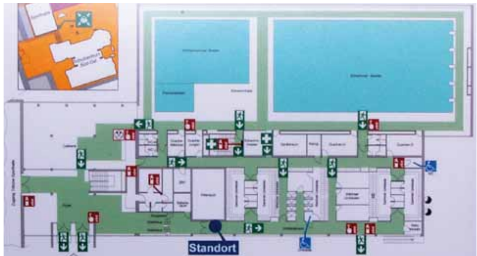
Flucht- und Rettungswegplan des Fildekenbades. Oben der Schwimmbereich, unten der Umkleide-trakt, links Cafeteria mit Foyer und angrenzender, baulich getrennter Sporthallenbereich.
