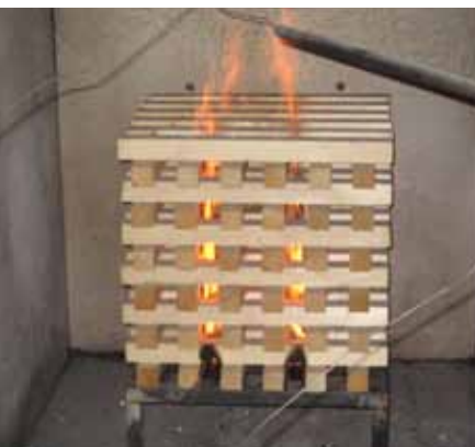
Aufbau eines Prüfstands zur Prüfung von Styropor WDVS. Das aus Rohöl gefertigte Polystyrol (Styropor) ist nur schwer entflammbar. Bei einer entsprechenden Wärmeenergiezufuhr brennt es jedoch sehr schnell ab.
