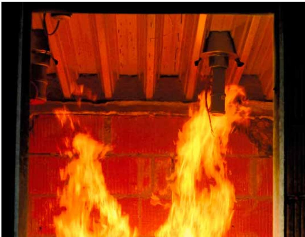
Für das von Dallmer entwickelte Brandschutzelement für Dachabläufe in Stahltrapezblechdächern ist nach der bestandenen Brandprüfung entsprechend DIN 18234 der erforderliche Eignungsnachweis gegeben.
