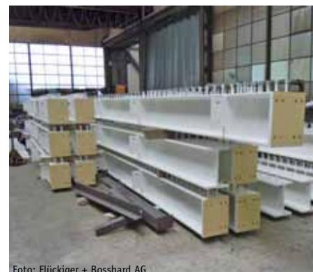
Bild 6: Im Werk mit „Unitherm platinum“ brandgeschützte Deckenträger
