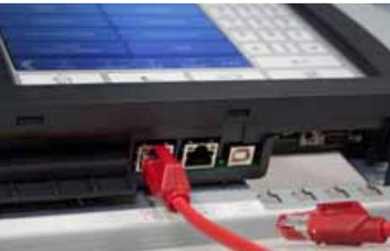
den Einsatz bei großen und komplexen Projekten wie beispielsweise Flughäfen oder Bahnhöfen. Die Kombination von Ethernet- und CAN-Netzwerken erhöht die Flexibilität in Netzwerkstrukturen. Das neue Farbdisplay mit Touchscreen erlaubt eine intuitive Bedienung des Systems. Alle Funktionalitäten entsprechen der europäischen Norm EN 54.
