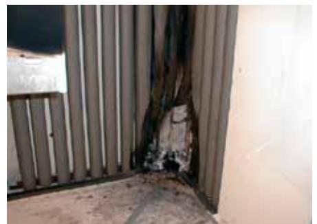
Abbildung 3: Der SBI-Test – hier am Beispiel von Armaflex-Schläuchen vor, während und nach dem Test.
