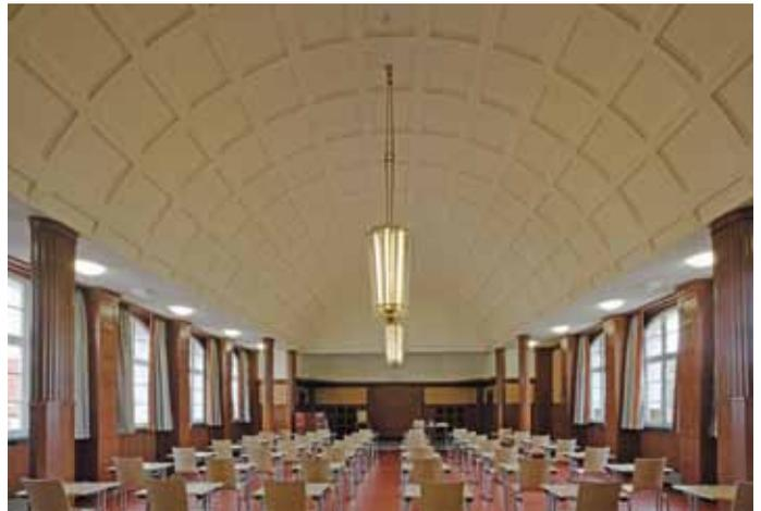
Die Schulaula in der dritten Etage ist mit einem repräsentativen Tonnengewölbe überkrönt, das mit Spanndrähten von den Dachsparren abgehängt ist.
