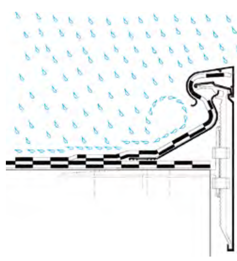
Überlaufsicherheit entsteht durch die profilbedingte S-förmige Ausformung der eingelegten Anschlussbahn und eines ausreichend hohen Überstandes
