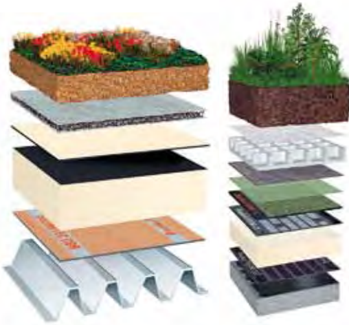
Gründachaufbau: Mehrschichtsysteme mit einer funktionalen Trennung von Vegetationsschicht, Filterschicht und Dränschicht haben sich für extensiv und intensiv begrünte Dächer durchgesetzt
